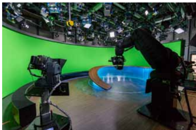
Abb. 2: Studio für BR Rundschau mit Kamera-robotern
