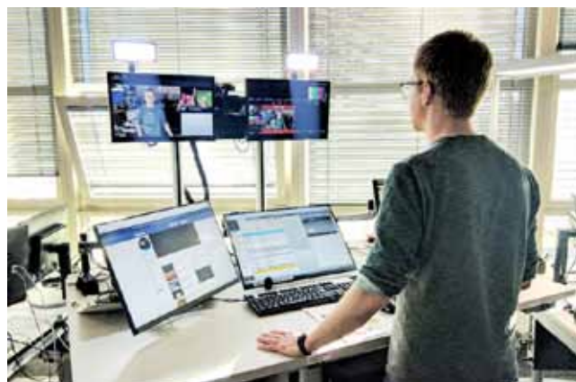
Abb.3: Assistierte Arbeitsumgebung für den Selbstfahrer am Moderationsplatz
